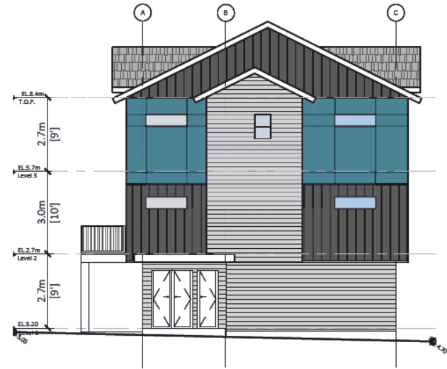
2 West/Left Elevation (Lane) 3/32"=1'-0"
