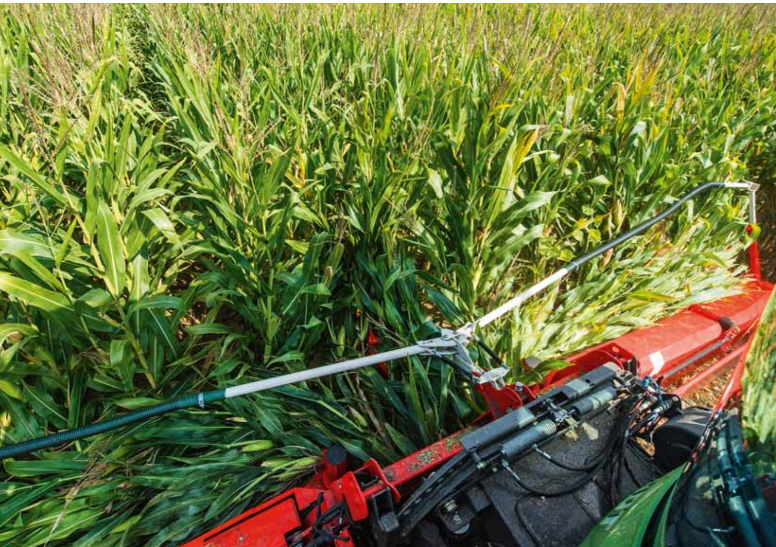
Drei Meter breite Pickup mit hydraulisch schwenkbaren Tristrädern. Maisgebiss wahlweise mit zehn oder zwölf Reihen lieferbar. Für Straßenfahrten lässt sich der Vorsatz innerhalb kürzester Zeit hydraulisch in Transportstellung klappen.
